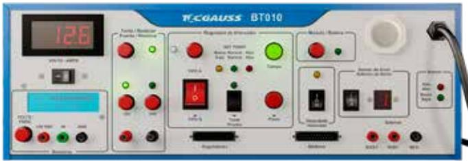
El Probador de Autopartes Electrónicas BT010 se diseñó especialmente para probar los componentes de los sistemas eléctricos y electrónicos de los vehículos motorizados.
