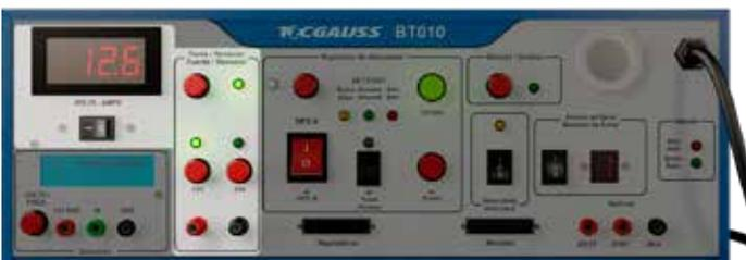
Al encender el probador, el módulo de prueba de la fuente estará desactivado. Para encenderlo, presione el botón "FUENTE/REINICIAR".
