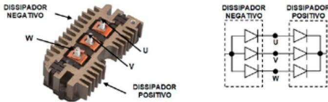
En la figura de arriba, hay un rectificador y la simbología equivalente. Para realizar la prueba, siga el procedimiento:
