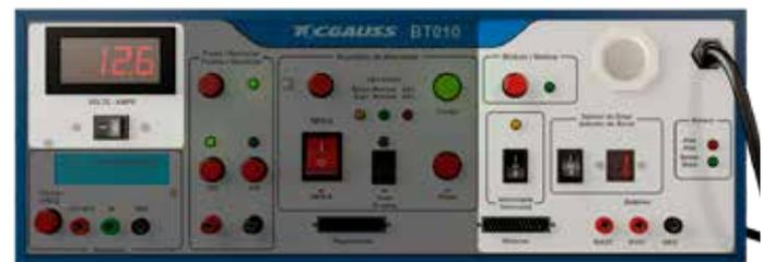
El módulo de prueba de módulos y bobinas de encendido funciona solamente a 12 Voltios. Para poder ingresar en este módulo es necesario que el probador esté en la condición inicial, es decir, la fuente esté en 12 Voltios y el módulo de prueba de reguladores esté deshabilitado. Este módulo está compuesto por las siguientes partes:
