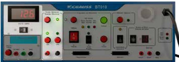
Ao ligar o Testador, o módulo de teste da fonte estará desativado. Para ligá-lo, pressione o botão "FONTE/REINICIAR". A tensão padrão na inicialização é de 12 Volts e, para alterar para 24 Volts, pressione o botão correspondente.
