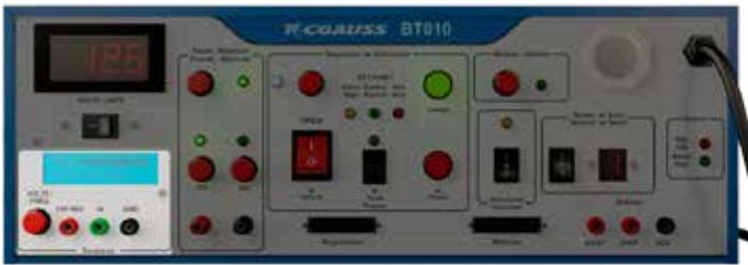
É composto por uma tela LCD de 2x16 caracteres, três plugues e um botão de pressão, permitindo testar os sensores conforme descrito no item 3.1 - Teste de Sensores.
