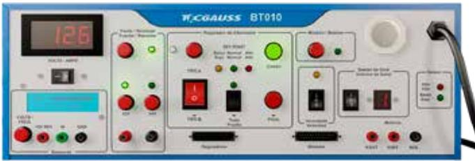
O **Testador de Autopeças Eletrônicas BT010** foi especialmente projetado para testar os componentes dos sistemas elétrico e eletrônico de veículos motorizados.
