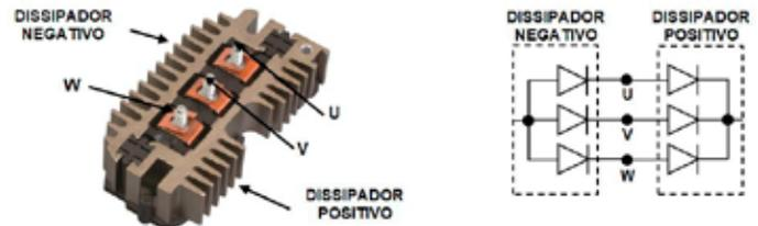
Na figura acima, há um retificador e a simbologia equivalente. Para realizar o teste, execute o seguinte procedimento:
