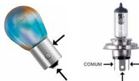
**OBSERVAÇÃO:** Para testar lâmpadas halógenas com três terminais (dois filamentos), conecte os cabos de ligação para o teste da “Luz Baixa” e posteriormente para o teste da “Luz Alta”. Se um dos filamentos não acender, a lâmpada está com defeito.
