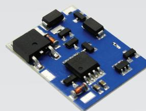
Circuito eletrônico fabricado sobre um substrato cerâmico (circuito híbrido), o que garante alto desempenho na dissipação de calor, maior confiabilidade e maior vida útil ao produto.
