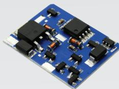
Circuito eletrônico fabricado sobre um substrato cerâmico (circuito híbrido), o que garante alto desempenho na dissipação de calor, maior confiabilidade e maior vida útil ao produto.
