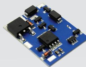
Circuito electrónico fabricado sobre un sustrato cerámico (circuito híbrido), garantiza alto desempeño en la disipación de calor, mayor confiabilidad y mayor vida útil al producto.
