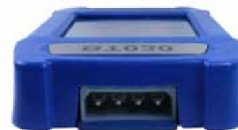
Fig. 2. Conector del cable de diagnóstico.
